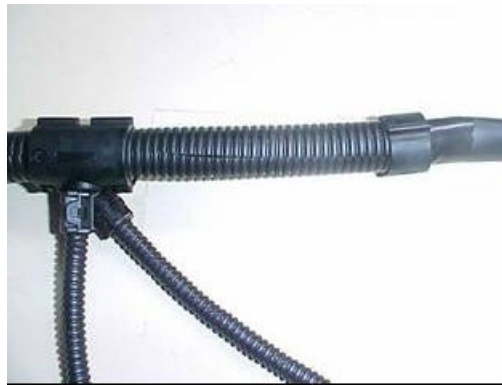
Figura 3.2 – Tubo corrugado revestindo um ramal de chicote
